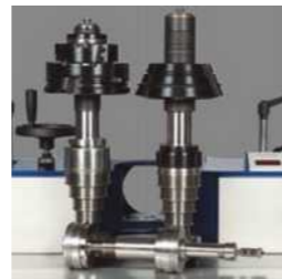
“クイックチェンジ” 軸簡易交換システム
