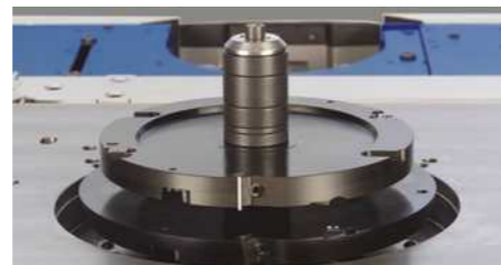
テーブル開口部 \phi 320\text{mm}
