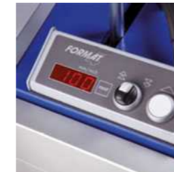
電動フェンス調整
