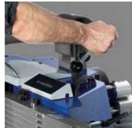
“定規クイッククランプ” 定規を簡単に固定 (オプション)
